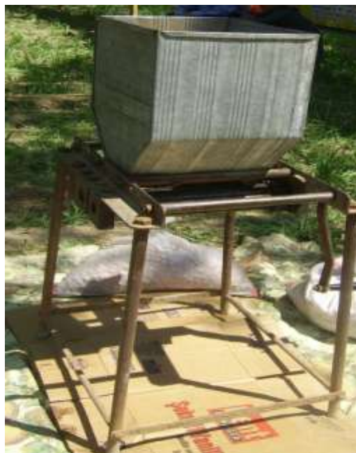
Рис 2. Самодельный механический аппарат для ломки косточки абрикоса.
